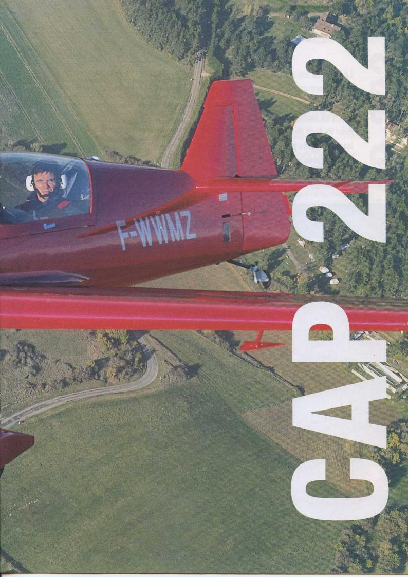
Le Cap 222 est un biplace de voltige aux performances époustouflantes pour une machine qui ne dispose que d'un moteur de 200 chevaux.
