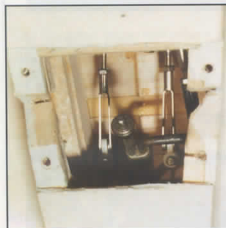
Commandes de profondeur et de direction, portée par un palier ménagé dans la trappe. L'interrupteur est placé en travers, dans la cabine, et commandé par une tirette.
