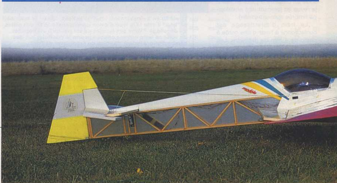
3 - Le Démoniak peut recevoir différentes motorisations, depuis le 6,5 cm 3 moderne avec réso jusqu'au 10 cm 3 standard (ce qui permet d'utiliser les vieux moteurs délaissés par la voltige F3A).
