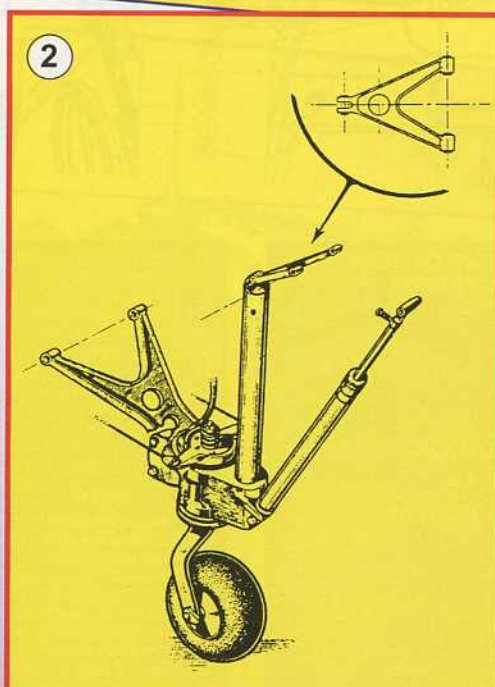
1) Jambe de train en position sortie, et détail du principe d'articulation pour permettre la position rentrée. Les nombreuses biellettes demanderont un long travail de tournage. 2) Roulette de queue 3) Croquis de la cinématique du train. Qui osera une telle réalisation ?
