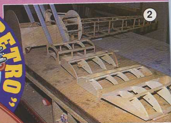
2- Voici donc les panneaux latéraux, supérieurs et inférieurs désolidarisés du fuselage.
