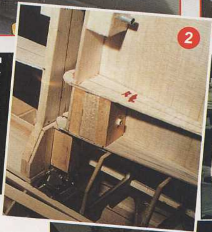
1) La partie supérieure du bombardier est amovible, elle permet d'accéder à la radio. 2) Détail de la commande de dérive. 3) Chantier de montage d'une demi-aile. 4) Demi-aile en construction sur ses supports. 5) Montage du servo d'aileron et détail des commandes aller et retour.
