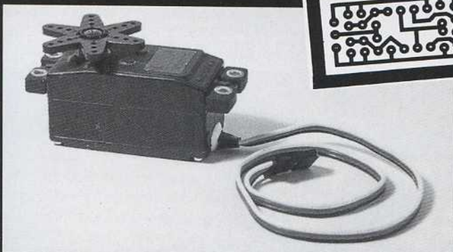
Ci-dessus : un servo spécial train rentrant Futaba FP-S 136 G sera heureux de bénéficier du montage de C. Stern. En haut : circuit imprimé (Ech. 1), base de ce montage électronique.
