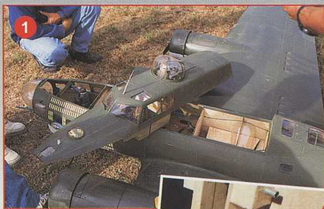
1) La partie supérieure du bombardier est amovible, elle permet d'accéder à la radio. 2) Détail de la commande de dérive. 3) Chantier de montage d'une demi-aile. 4) Demi-aile en construction sur ses supports. 5) Montage du servo d'aileron et détail des commandes aller et retour.
