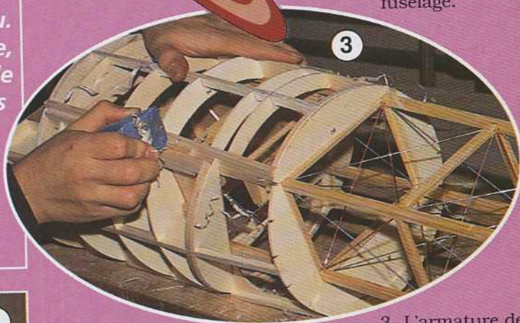
3- L'armature de ces panneaux doit être poncée, pour permettre la pose des coffrages.
