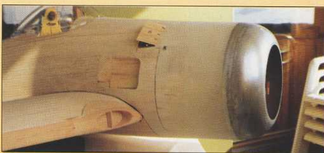
Photo illustrant le schéma ci-dessus : On distingue le masticage. Notez également les ouïes de refroidissement, qui devront être impérativement ouvertes.
