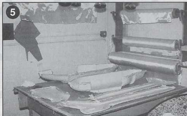
Photo 5 : On voit ici un fuselage de Cessna en cours de moulage selon la technique du "sandwich Nomex". Les photo 4 et 7 donnent un aperçu du résultat obtenu.
