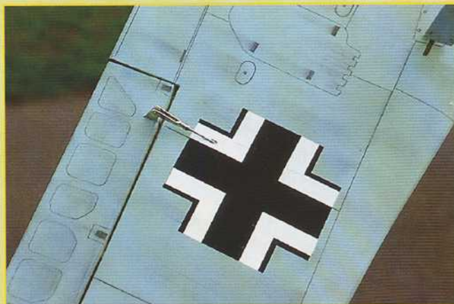
La commande d'aileron est très discrète. Le "vieillesiment" est effectué à la mine de crayon grasse (2B) frottée.
