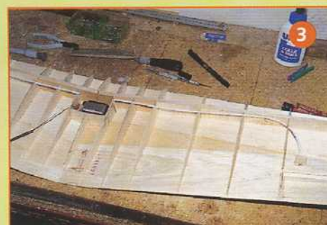
1) Début de la structure d'une demi-aile : coffrage d'intrados avec les nervures, clé d'aile, logement d'aileron et âmes verticales. 2) Le servo d'ailerons est placé à plat dans l'aile. 3) Les gaines des commandes d'ailerons cheminent juste sous le coffrage d'extrados.
