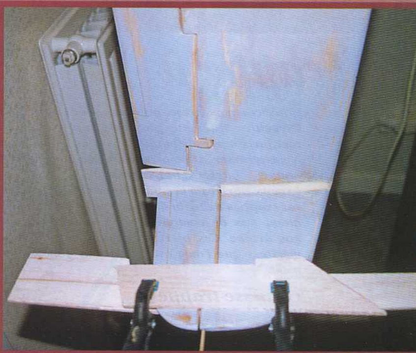
Ci-dessous : les empennages sont, à présent, entièrement marouflés.
