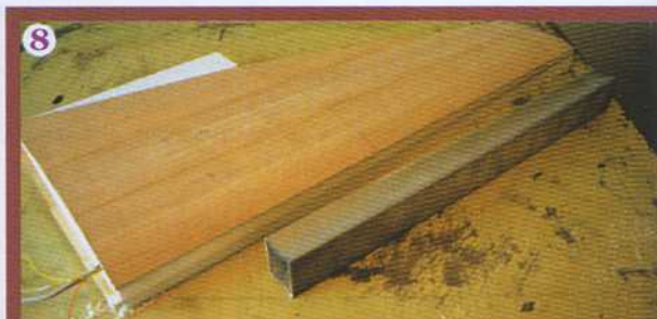
8 - Préparation de la mise en place du bord d'attaque. 11 - Les deux noyaux, fin prêts à rejoindre la voilure.
