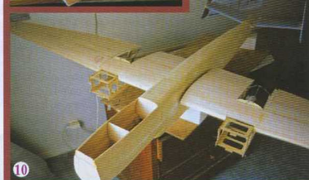
10 - La voilure complète. La partie centrale est réalisée en structure traditionnelle tandis que les extrémités sont en mousse coffrée.
