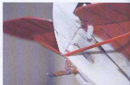
**Détails de l'arrière du modèle : sorties de commandes et patin arrière.**
