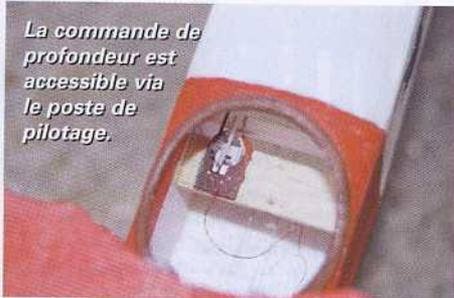
La commande de profondeur est accessible via le poste de pilotage.
