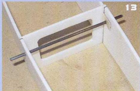
10) Les flancs du fuselage. 11) Mise en place des couples. 12) Les renforts d'assise de l'aile. 13) Un des deux tourillons de fixation de l'aile.
