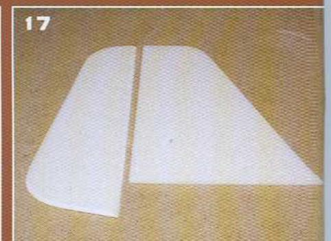
14) Le plan de profondeur. 14 bis) Les gouvernes de profondeur sont réunies par un morceau de tube carbone. 15) La baguette servant à rigidifier le plan fixe de profondeur. 16 et 17) Le plan vertical avant et après découpe du volet de direction. 18) Les empennages sont en place : notez les renforts à la base du plan vertical.
