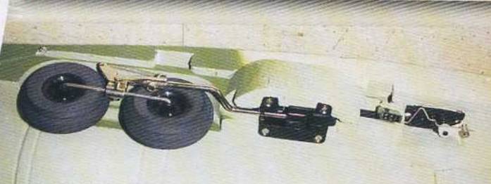
Le train principal est vraiment original et solutionne de façon finalement simple une cinématique complexe.
