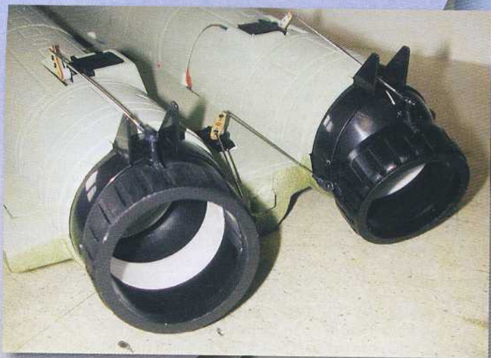
Les tuyères orientables et leurs servos. Poussée vectorielle pilotée en tangage, lacet et roulis.
