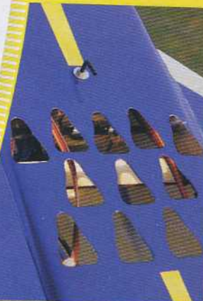
Les commandes de profondeur et dessous, le crochet de catapultage et les ouïes supplémentaires.
