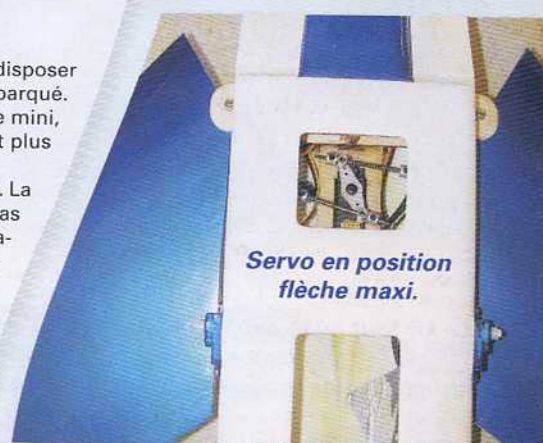
Les commandes de la flèche sont sur rotules.
