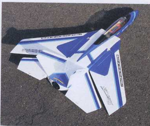
Flèche maxi à gauche, flèche mini à droite. Faible portance et faible traînée à gauche, forte portance et plus de traînée à droite. C'est ça, la géométrie variable.
