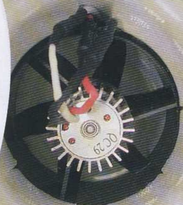
Le brushless inline et la turbine vus depuis la tuyère.
