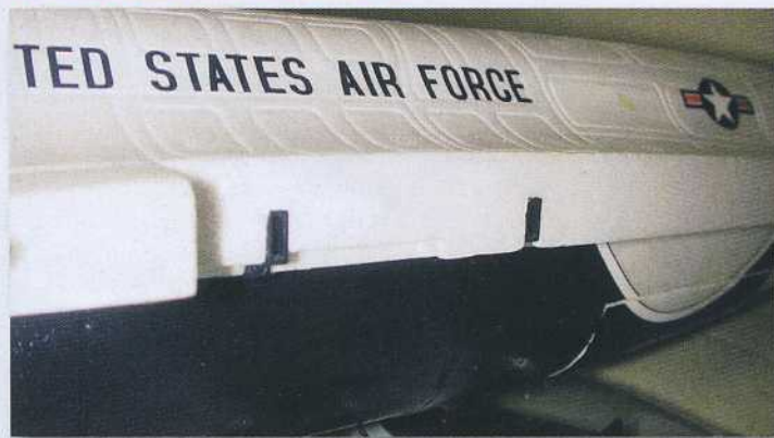
Très bon point, les ailes sont montées avec des clés, et non juste en bout contre le fuselage.
