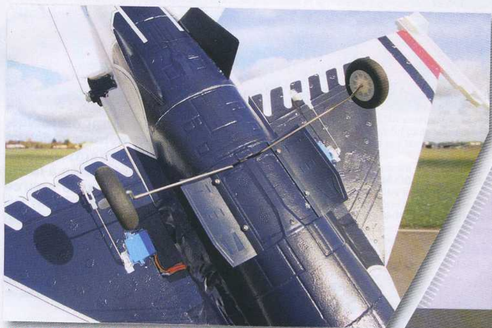
Vue sur le train principal et sur les servos d'ailerons. Notez aussi les quilles ventrales conformes au réel. A droite, le train avant et la fente en fond de fuselage qui lui permet de se plier légèrement vers l'arrière en cas de petits chocs.
