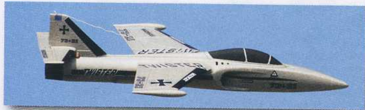
Archétype du jet en EPP, le Twister de Multiplex est moulé en Elapor, variante de super qualité de ce matériaux robuste.
