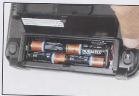
Le porte piles de l'émetteur. Une prise de charge est disponible, si on utilise les accus NiMH.
