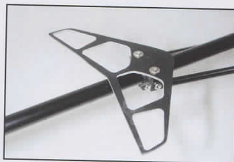
Un gros plan sur le petit stabilisateur, plus esthétique que fonctionnel.
