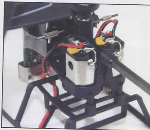
Deux minuscules moteurs assurent l'entraînement des deux rotors.
