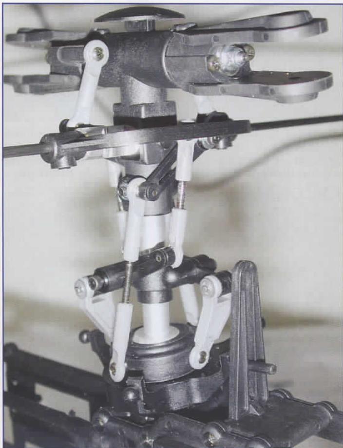
A gauche, une tête "classique" avec barre de Bell et ci-dessus, une tête "flybarless". Le plateau cyclique pilote directement les pales, même si le compensateur de pas reste en place.
