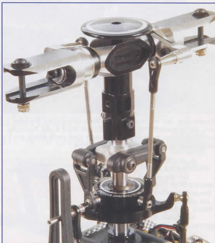
A gauche, une tête "classique" avec barre de Bell et ci-dessus, une tête "flybarless". Le plateau cyclique pilote directement les pales, même si le compensateur de pas reste en place.
