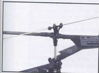
Les têtes de rotor : la supérieure avec barre de Bell assure la stabilité, l'inférieure commandée par le plateau cyclique permet le pilotage.
