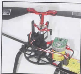
Voici l'architecture de la mécanique. Un bloc électronique, un moteur, deux servos.
