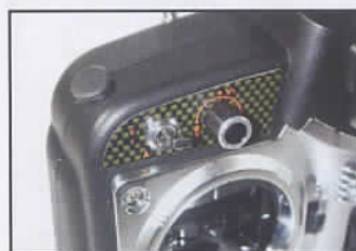
A gauche, inter et potentiomètre de limitation de puissance, et à droite, le dual rate.
