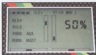
L'écran affiche la position des trims, et permet le choix du mode de pilotage et l'inversion des commandes.
