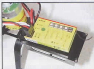
Gros plan sur le boîc électronique "tout en un" et ses réglages.
