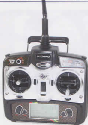
L'émetteur 2,4 Ghz est un 4 voies toute simple, mais avec réglages sur écran.
