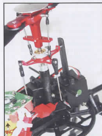
L'ensemble plateau cyclique et tête de rotor sont en alu, du robuste !
