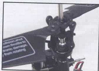
Les têtes de rotor : la supérieure avec barre de Bell assure la stabilité, l'inférieure commandée par le plateau cyclique permet le pilotage.
