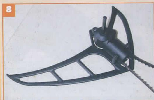
**8** - Le boîtier d'anticouple en deux demi coquilles est assemblé après avoir installé deux roulements de 5 x 10 x 4 dans chaque moitié et en emprisonnant l'axe d'anticouple. On aura aussi placé la courroie crantée sur la poulie. Les vis M3 x 25 et M3 x 20 et écrous nyltrops M3 fixent au passage la dérive, très ajoutée et qui sert plus de patin de protection de l'anticouple.
