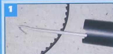
**1** - Fabriquez un crochet et tirez la courroie dans le tube de queue. Notez que la face arrière du tube de queue possède des usinages en demi-cercle qui l'immobilisent en rotation. **2** - Glissez l'ensemble du boîtier d'anticouple sur le tube de queue et finissez de serrer les 3 vis. Montez le rotor anticouple et immobilisez le avec sa vis de pression et du frein filet. Raccordez les chapes du coulisseau aux pieds de pales..
