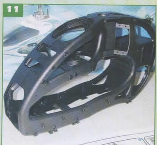
**9** - Posez les deux roulements de 10 x 19 x 5 dans leurs logements du flanc droit. **10** - Après avoir installé le galet tendeur dans le flanc gauche, réunissez les deux flancs à l'aide de 16 vis M 2,5 x 10 et 4 vis M 2,5 x 16. Ces dernières ne sont pas serrées pour le moment. **11** - Voici notre châssis terminé. Il est très rigide et visiblement facile à équiper.
