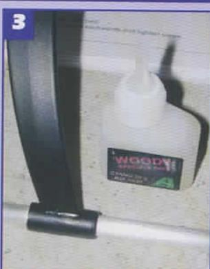
**1** - Nous pouvons maintenant fixer le train à l'aide de 4 écrous M3 nylstop et 4 vis M 3 x 10. En **2**, nous voyons comment les écrous sont noyés dans le flanc. **3** - Nous glissons ensuite les patins en tube alu dans les trains. Ils couissent facilement, il faut un point de cyano plus un peu d'accélérateur en bombe ou spray pour les fixer solidement.
