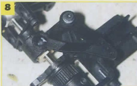
**7** - Montez l'ensemble de l'anticouple en emprisonnant la poulie. Une vis de pression M3 x 4 verrouille le montage. **8** - Il reste à installer le renvoi de la commande d'anticouple. Un peu de graisse téflon sur la rotule rendra le mouvement très doux. Notons que l'anticouple est identique au premier Eco 8. Seules les pales sont nouvelles.
