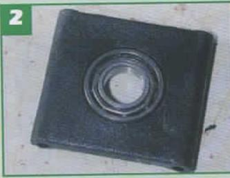
**1** - Voici les nouveaux flancs de châssis moulés de l'Eco 8 Royal, qui lui confère une rigidité bien supérieure au châssis de l'Eco 8. Ils reçoivent la même plaque de base que l'ancienne version et donc si on le désire, la plaque de base métal optionnelle. **2** - On va installer un roulement 6 x 12 x 3 dans la plaque support supérieure. C'est le second guide pour le mât rotor.
