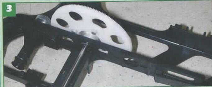
**3** - La plaque de base est vissée contre le flanc droit à l'aide de 7 vis M2 x 8. **4** - La plaque supérieure et son roulement sont enfilés sur le mât rotor (attention à ne pas perdre le petit pion qui est en bas...), puis est vissée à son tour dans le flanc droit par 2 vis M 2 x 8. On monte la bague d'arrêt du mât en alu, et on la serre sans la bloquer pou le moment avec une autre vis M 2 x 8.
