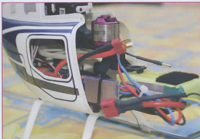
La mécanique d'origine se loge dans la carrosserie moyennant un démontage de l'anticouple.
