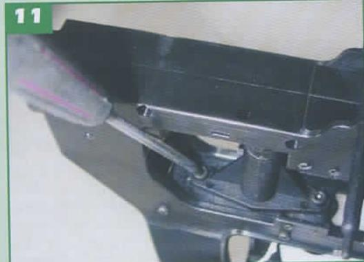
**10** - L'ensemble de la transmission de l'anticouple est maintenant poussé contre la couronne principale, une bandelette de papier permet de régler l'entre-dents. Le papier doit être bien marqué, mais pas se déchirer. **11** - On serre alors définitivement les deux vis du support. Comme on ne peut visser droit, il est pratique **(12)** d'utiliser un tournevis hexagonal à tête rotule.
