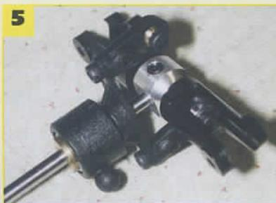
**4** - Les chapes sont montées sur le coulisseau avec des vis M2 x 6 (bloquer sans exagération). **5** - Le rotor est mis en place sur son axe, une vis de pression M3 x 4 (frein filet), puis, le coulisseau est glissé sur l'axe et les chapes raccordées.
