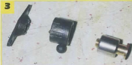
**3** - Nous assemblons maintenant les 4 pièces du coulisseau. La douille noire doit être collée sur le roulement avec précaution (cyano). Dans notre kit, notons que les pièces détachées étaient fournies, mais qu'un ensemble prémonté était également fourni...
