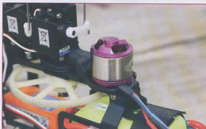
**Option intéressante à plus d'un titre, le moteur brushless : pratiquement inusable, il offre un gain de poids et de puissance non négligeables. Le pignon doit être monté en force avec précautions.**
