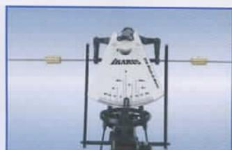
**Pour les réglages de pas et l'équilibrage des pales, il existe un set d'outils dédiés à cet usage chez Ikarus. A droite, l'incidencemètre installé sur une tête d'Eco 8.**
