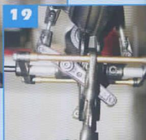
**16** - Assemblez les deux bielettes de commande de la barre de Bell, de 54 mm de long. **17** - Montez les sur les renvois de commande de la barre de Bell en laiton. **18** - Montez les renvois sur les balancelles à l'aide de vis M2 x 6 plus frein filet, et clipsez l'autre extrémité sur les boules du wash out. **19** - En veillant au parallélisme des renvois en laiton, serrez définitivement les vis de pression des balancelles sur la barre de Bell.
