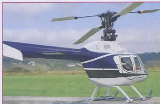
pour le Jet Ranger. Le fuselage se sépare en 2, il ne reste qu'un très peu de travail. Il faut percer des trous pour fixer la partie avant sur la partie arrière, puis coller les petits carrés de bois derrière les trous afin d'assurer le maintien de la petite vis à bois. Les mêmes actions sont à réaliser pour la fixation de la vitre avant. Afin de réaliser le montage du Tiny dans le Jet Ranger, faut procéder à quelques modifications :
