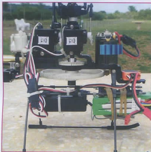
**A nouveau le comparatif entre la version Tiny III, ci-dessus, et EVO plus options à droite : on note le nouveau châssis bien plus facile à équiper, le montage du moteur Brushless, la transmission d'anti-couple à courroie, mais aussi un train bien plus sérieux.**
