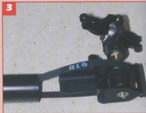
**1** - La courroie crantée est placée sur la poulie côté anticouple, et on visse la barre de protection arrière (2 vis M2 x 6). **2** - Montez sur la tige de commande d'anticouple d'un côté une chape à boule et de l'autre la chape plastique blanche. Utilisez cette commande pour "tirer" la courroie crantée à l'intérieur du tube de queue en veillant à ne pas la vriller. **3** - Rentrez le support d'anticouple dans le tube jusqu'en butée.
