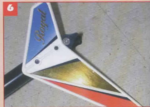
**4** - Montez la dérive avec la seule vis arrière M2 x 8. Ensuite, à l'aide d'une mini perceuse et d'un foret de 1,7 mm, percez le tube alu en utilisant le trou de fixation avant comme guide. Ensuite seulement, vissez la vis avant M2 x 8. **5 et 6** - Posez dès à présent le décor de la dérive, c'est plus facile qu'une fois le tube de queue en place sur le châssis. Utilisez un cutter avec une lame neuve pour réaliser une découpe juste à l'intérieur des reliefs moulés.
