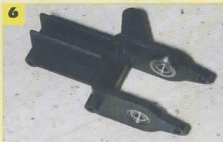
**6** - Dans le support de l'anticouple, placez les deux roulements épaulés 3 x 7 x 3 mm, par l'intérieur.
