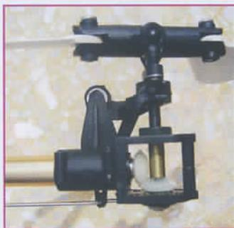
**A gauche, la transmission à pignons d'origine, et à droite, la transmission option, par courroie. Plus souple, plus légère et plus tolérante aux chocs.**
