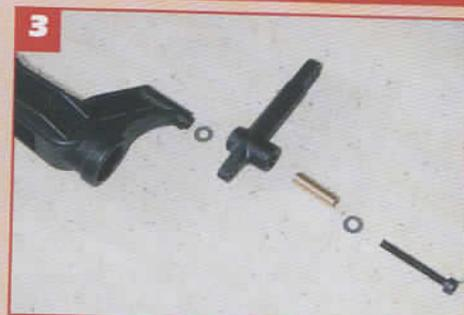
**1** - Préparez les chapes coudées en faisant sauter les petites barres obliques à l'aide d'un cutter (c'est plus facile qu'il n'y paraît). **2** - Assemblez les 4 biellettes aux cotes de la notice (39 et 45 mm). **3** - Assemblez les bras de renvoi vers la barre de Bell sur les pieds de pales.
