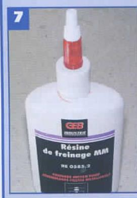
**7** - A prévoir impérativement, le flacon de frein-filet "moyen". Vous l'utiliserez pour assurer les liaisons par vissage métal sur métal, sauf dans le cas d'écrous nylstop pour lesquels le freinage est lié à une bague nylon intégrée à l'écrou. N'utilisez pas non plus de frein filet pour les vis prises dans du plastique, le produit n'est pas fait pour ça, peut dégrader le plastique et le vissage dans du plastique est auto-freinant.
