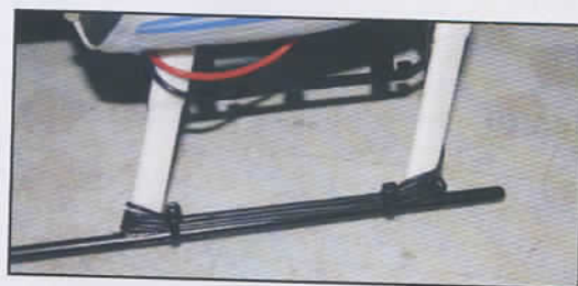
L'antenne est enroulée autour d'un patin. Cela ne pose pas de problème ici, car on vole en général près de soi.
