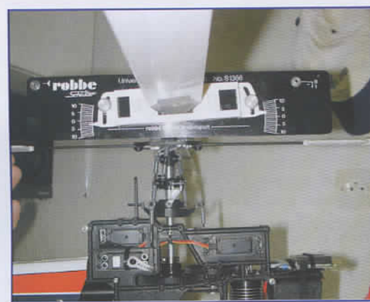
Réglage du pas mini (-3° pour cet exemple).
