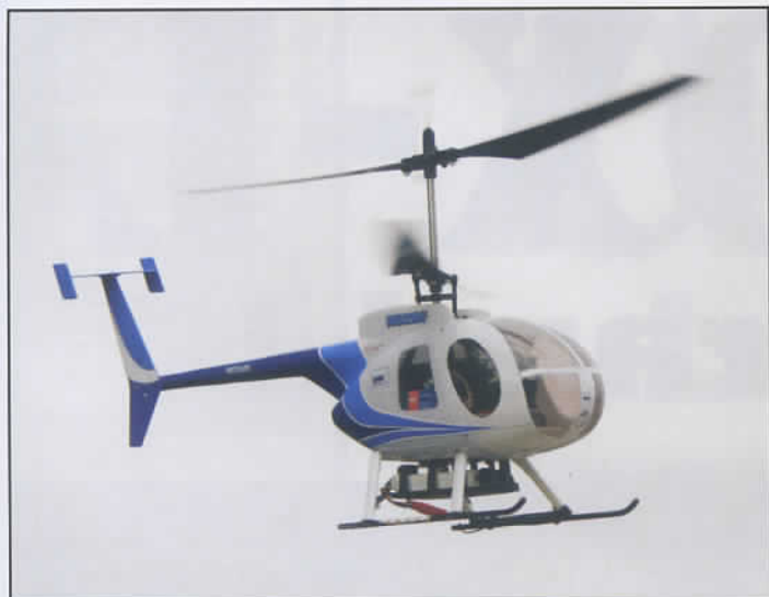
La carrosserie de Hughes 500 ajoute beaucoup au réalisme. La partie avant se démonte en enlevant des minuscules vis.
