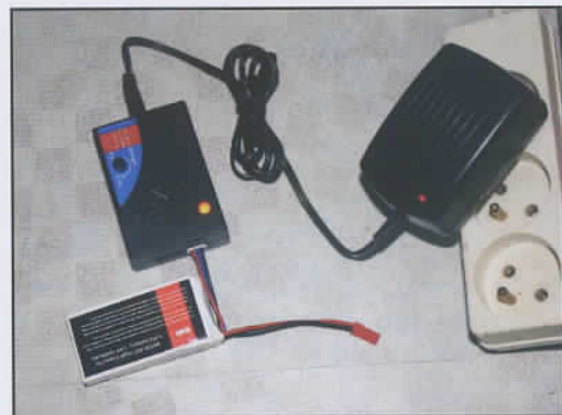
Le chargeur d'accu est composé d'un bloc d'alimentation et du chargeur proprement dit.
