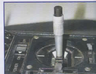
Le manche à mi-course on maintient la barre de Bell perpendiculaire au mât rotor et on règle sur la radio de manière à avoir le dessous de l'incidence-mètre parallèle à la barre de Bell.
