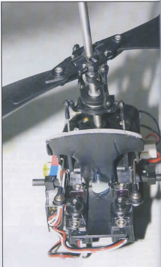
La tête de rotor inférieure est pilotée via un tableau cyclique simple, dont les servos agissent sur le longitudinal et le latéral.
