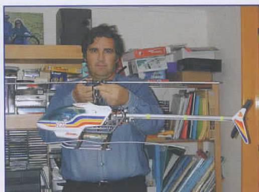
Centrage d'un hélico : en le tenant sous la barre de Bell, à gauche, peu précis, ou en le prenant par la tête de rotor à pleine main, beaucoup plus efficace, à droite. Le fuselage doit rester horizontal.
