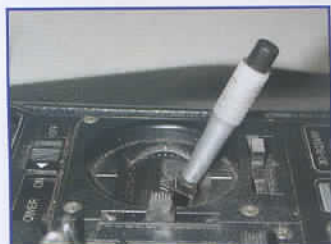
Réglage du pas mini (-3° pour cet exemple).
