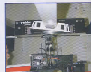
Le manche à mi-course on maintient la barre de Bell perpendiculaire au mât rotor et on règle sur la radio de manière à avoir le dessous de l'incidence-mètre parallèle à la barre de Bell.
