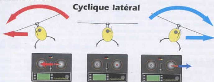
Cyclique latéral vers la gauche, inclinaison à gauche et translation vers la gauche
