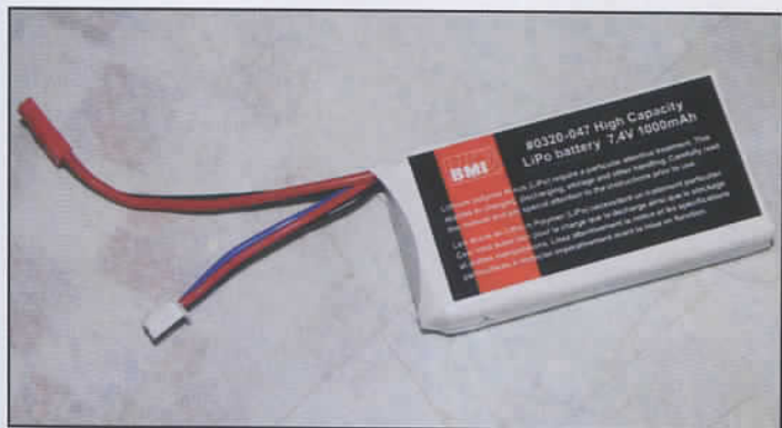
Le pack d'accus est un 7,4 v Li-Po de 1000 mAh doté de sa prise d'équilibrage.
