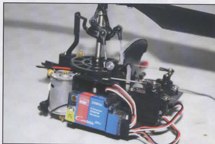
Le récepteur est un six voies FM, dont seulement 4 sont utilisées. On voit bien ici les renvois des commandes du plateau cyclique.
