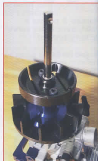
Présentation typique d'un moteur thermique hélicoptère. Ici, il s'agit d'un moteur Thunder Tiger.
