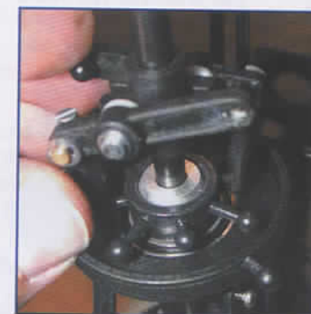
Sur ce plateau à trois points, la bague intérieure possède deux jeux de points d'ancrage, pour disposer de 2 sensibilités.
