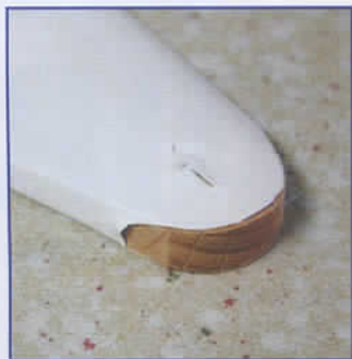
Les pales bois sont fréquemment livrées terminées et entoilées comme ici ces pales Ikarus d'Eco 8
