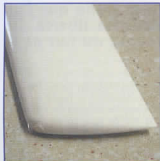
Extrémité d'une pale en mousse Kyosho. Un ponçage du bord d'attaque est souvent nécessaire, terminé par la pose d'un adhésif fin sur tout le bord d'attaque.
