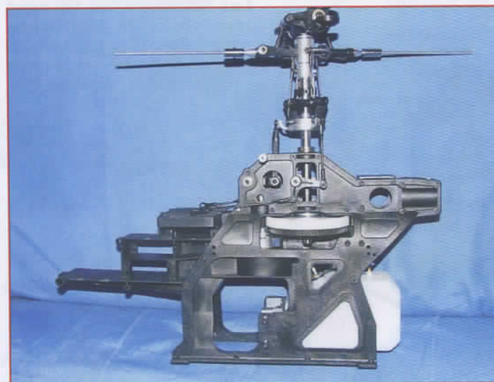
Comme il existe les "ready to fly" en avion, il existe des mécaniques hélico livrées prêtes à équiper, le montage de base étant terminé dès la sortie de la boîte. Ici, le châssis du Knight 50.
