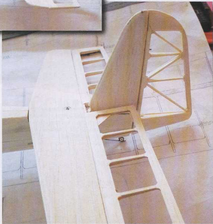
Gros plan sur la structure des stabs, à construire légers.
