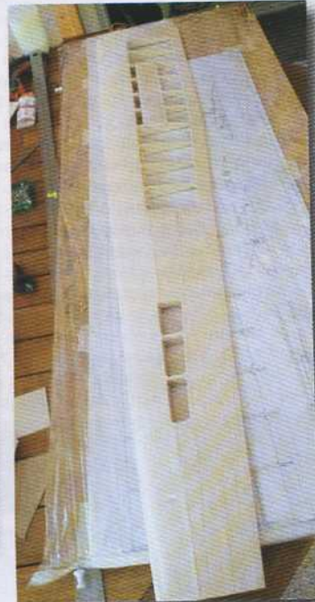
L'aile après coffrage de l'extrados.
