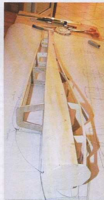
Cette vue permet de bien visualiser l'évolution des couples.
