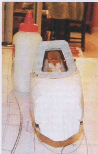
Vu de face, on voit la forme à facettes du fuselage.
