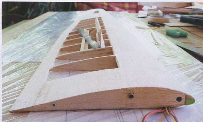
Cette vue montre le profil NACA 4412 utilisé, très à l'aise sur ce type de petite maquette.
