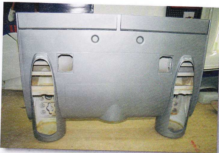
La partie centrale de l'aile, cœur névralgique de l'avion, est moulée en fibre de verre. Elle intègre une structure en bois. La peau est doublée par un nid d'abeille stratifié.
