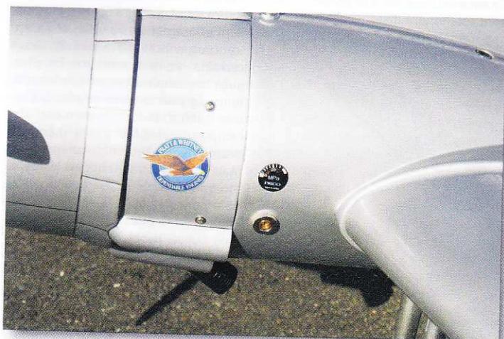
Sur la nacelle moteur gauche, la valve du train et son manomètre de pression.
