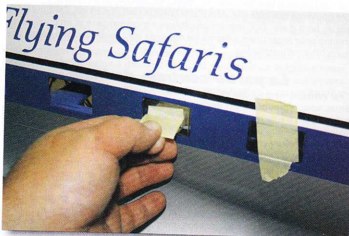
Astuce pour mettre les vitres en place pendant le collage : un petit bout de ruban adhésif plié en deux.
