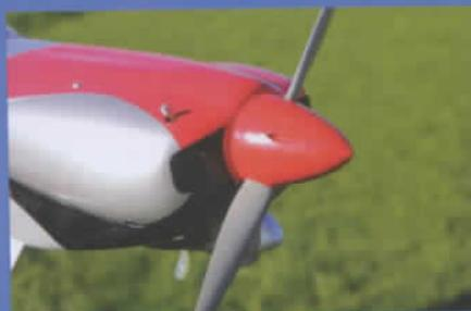
Un moteur de 15 cc 2 temps monté à 45° ne dépasse pas du capot, seul le pot dépasse en dessous du fuselage.
