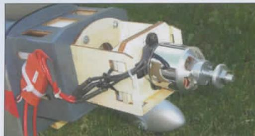
En électrique, c'est un brushless Turnigy SK3 5055 (378 g et un KV de 430 tr /V) qui a été utilisé. Il est monté sur un bâti bois spécifique (livré avec l'avion) et le contrôleur 80 A est installé sur le côté du bâti. L'accu est un LiPo 6S 4000 mA.
