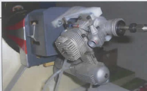
En version thermique, c'est ici un O.S 91 FX (15 cc deux temps méthanol) qui a été choisi. Il a été installé avec le cylindre aux trois quarts vers le bas, ce qui permet de positionner le silencieux sous l'avion.
