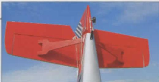
Le plan stabilisateur de type planche possède des haubans fidèles à l'original. Ces derniers ont une fonction purement esthétique. Sur les commandes, les chapes en métal sont fournies d'origine.
