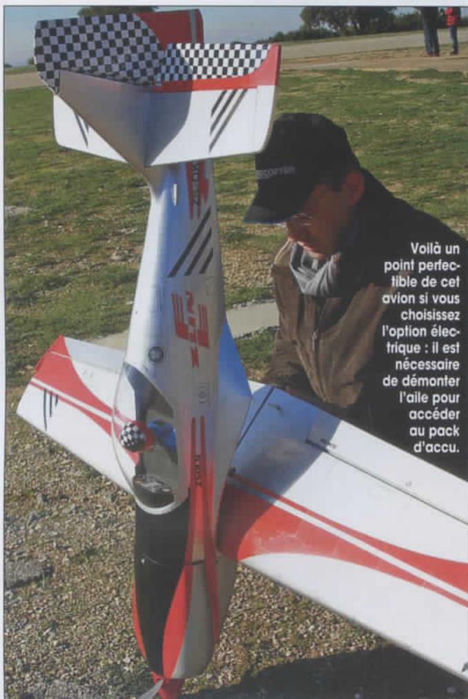
Voilà un point parfait de cet avion si vous choisissez l'option électrique : il est nécessaire de démonter l'aile pour accéder au pack d'accu.
