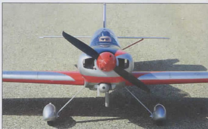
Le pot d'échappement de l'O.S 91 FX se fait oublier sous le capot et ne dénature pas trop les lignes de l'avion.
