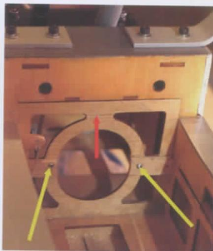
Le support du réservoir a été recoupé et modifié pour autoriser l'introduction de ce dernier dans son logement, ou sa dépose éventuelle. Les flèches jaunes indiquent l'emplacement des deux vis et la rouge, la ligne de coupe indispensable.
