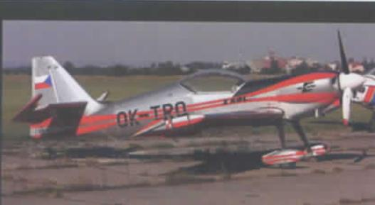
Caractéristiques : Envergure 8,58m, longueur 6,62 m, masse 720 kg, moteur Lycoming AE10-540-D4B5, vitesse max 290 Km/h. Source partielle: site web Wikipedia
