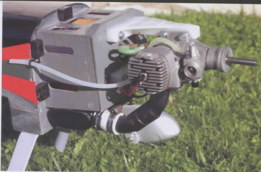
L'installation du groupe motopropulseur a été repensée par l'auteur et totalement dissimulée sous le capot. Ceci a imposé, entre autres, d'incliner le moteur à 90° et de braser un échappement spécifique
