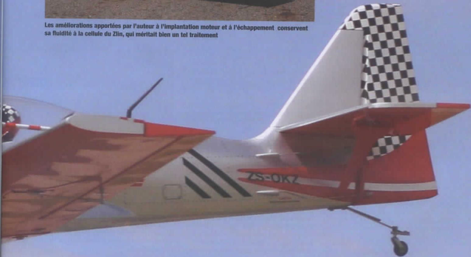
méchant). Seagull Models a amélioré son produit avec quelques détails maquette. Le rivetage et certaines trappes de visite sont imprimés sur l'entoilage et des chevrons ont été peints sur l'aile et l'empennage.
