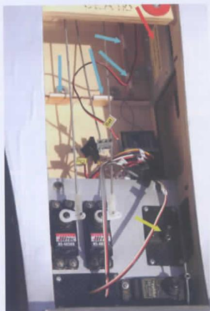
**Le compartiment radio assez vaste autorise une installation très propre : les servos et l'inter (flèche jaune) sont vissés sur une platine démontable, et les antennes du récepteur 2,4GHz (flèches bleues) sont guidées par des tronçons de tube (flèches vertes). Le logement de l'accu de réception (flèche rouge) est en arrière du bord de fuite de l'aile**
