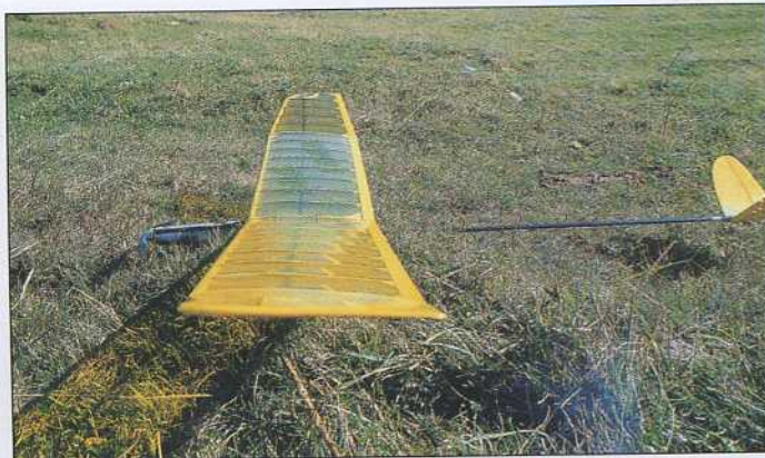
Cette vue de profil montre à quel point la traînée est réduite au minimum grâce à un fuselage très fin et des ailes dont le profil fait 7,1% d'épaisseur relative.
