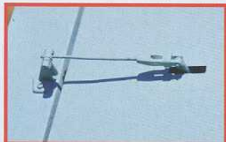
Commande d'aileron assurée avec un morceau de durit.
