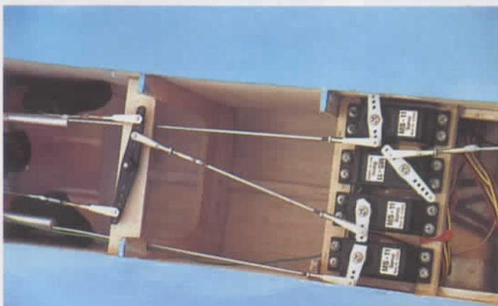
L'installation des servos. Notez le renvoi intermédiaire de la commande de direction.
