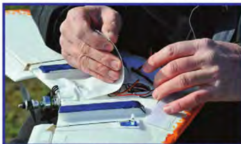
L'électronique et les 2 accus (nécessaires au centrage, mais qui servent l'un après l'autre !) sont "ca-mouflés" sous des bandes de Velcro ou du scotch autocollant. Minimaliste, on vous a dit !
