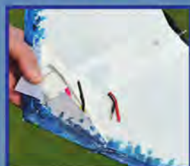
Version encore plus simple et light, la "Miniaile" est dotée d'un seul accu, le moteur est avancé et les servos sont à l'extrados.
