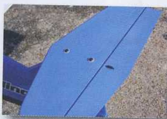
Seule modification apportée, la fixation du stabilisateur confiée à des vis CHC M3 à la place des vis Parker.
