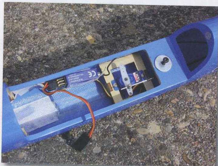
Le petit fuselage accueille le servo de profondeur et le récepteur. Le contrôleur est logé à l'avant.
