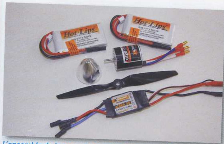
L'ensemble de la motorisation préconisée par Topmodel avec un moteur Inrunner XA 2810/6, le contrôleur X Reg 30, l'hélice 6 x 4, et les packs d'accus 2 et 3 S en 750 mAh.
