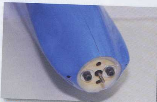
Le couple avant est collé d'origine. Il suffit d'y visser le moteur en place.
