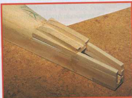
21) Collez les supports latéraux de la dérive sur l'arrière du fuselage
