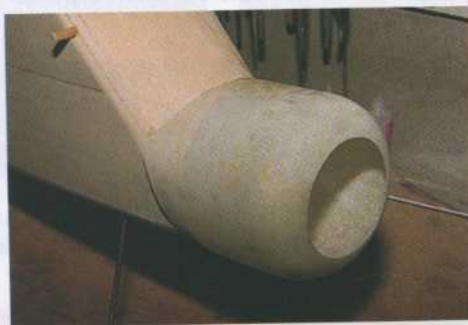
24) Le capot moteur est fabriqué en fibre de verre époxy à partir d'un moule perdu (cette technique de fabrication a été décrite dans Looping n° 44).
