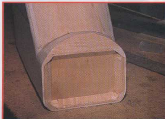
16) Renforcez le collage du couple pare-feu avec des baguettes triangulaires (8 x 8).
