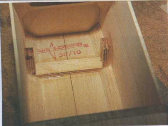
18) Le support rainuré comporte des profilés qui remontent à l'intérieur du fuselage. Ce système classique est utilisé sur 90 % des avions de début.
