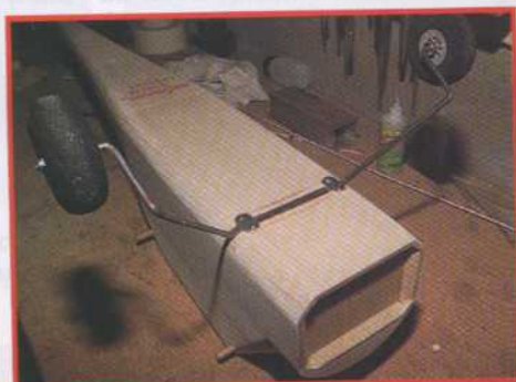
25) Pliez les cordes à piano Ø 4 selon le plan, c'est ce qui va donner le look inimitable à votre Wilga.
