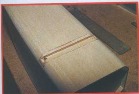
17) Découpez le dessous du fuselage et placez le support rainuré de train d'atterrissage.
