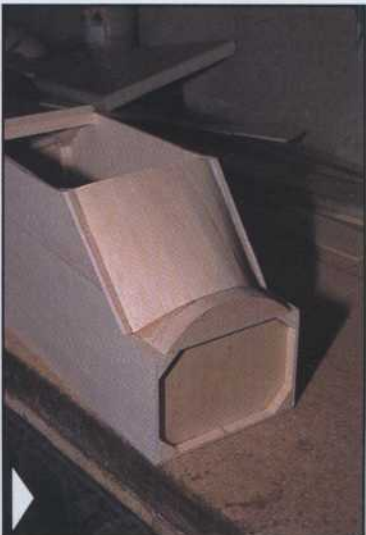
16) Renforcez le collage du couple pare-feu avec des baguettes triangulaires (8 x 8).
