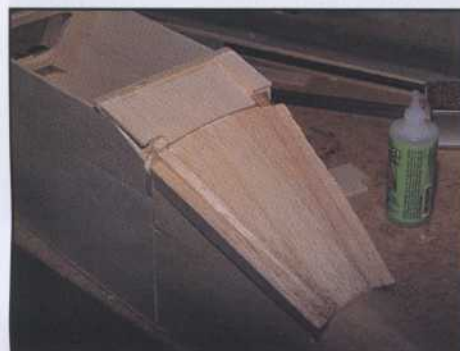
11) Terminez cette partie en remplissant les trous par des blocs de balsa, planche de 30/10 et morceaux de planche de 100/10.
