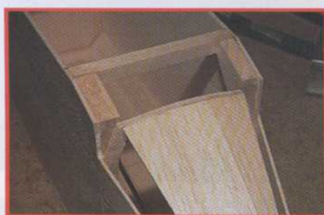
10) Collez la barre de bord de fuite et les blocs latéraux devant le couple C3.
