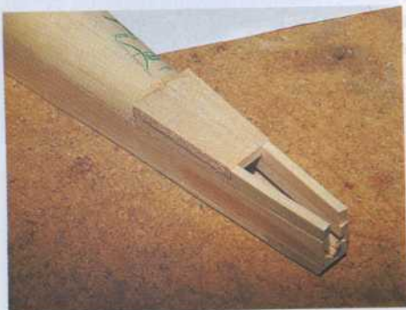
20) Collez des baguettes découpées et un bloc formant l'assise de dérive pour prolonger le profil arrière du fuselage.
