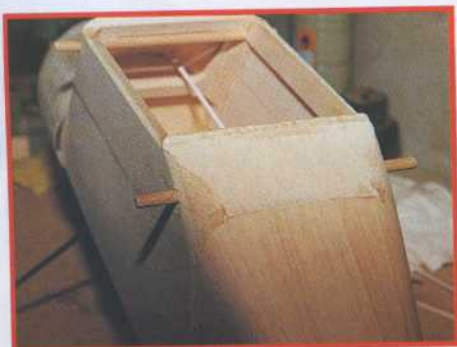
23) Percez les flancs de fuselage et collez les tourillons de maintien de l'aile.
