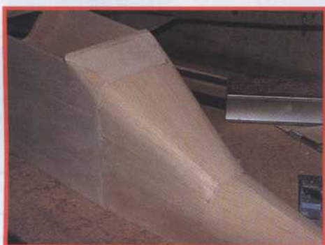
12) Après rabotage et ponçage, vous devriez obtenir quelque chose qui ressemble à cela.
