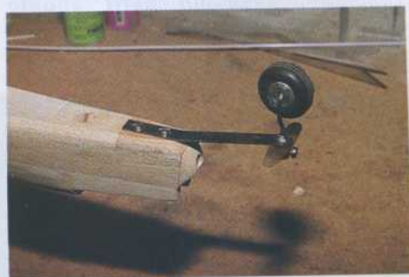
26) La roulette de queue est constituée d'une lame de ressort, de deux bagues d'arrêt Ø 2 mm et d'un morceau de corde à piano de 2.
