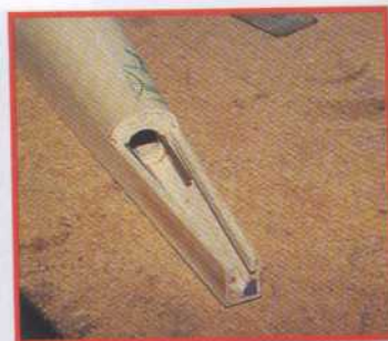
19) Collez deux baguettes de 5 x 5 pour renforcer les flancs à l'arrière du fuselage.
