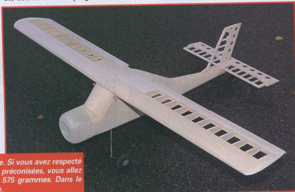
24) Le capot moteur est fabriqué en fibre de verre époxy à partir d'un moule perdu (cette technique de fabrication a été décrite dans Looping n° 44).
