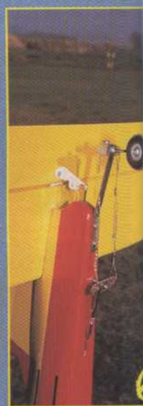
La commande de direction passe au travers du stab et du fuselage (notez le trou au bas de la gouverne). La roulette est amortie avec des ressorts.
