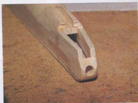
22) Collez un bloc de balsa à l'arrière et ménagez-y un trou pour le passage de la commande de profondeur.
