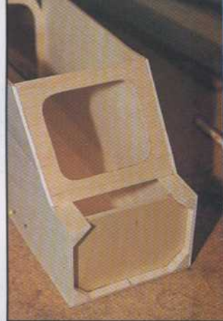
7) Collez le couple pare-feu C1 (contre-plaqué aviation 50/10) et le couple interne C2 de cabine (balsa 50/10).
