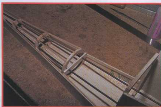
6) Collez les gaines de commande de direction et de profondeur. Attention, la gaine de direction sort sous le fuselage (voir plan) et non à l'intérieur du fuselage comme sur cette photo.
