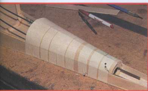
8) Coffrez l'arrière du fuselage en balsa 20/10. Bien maintenir avec du ruban adhésif.
