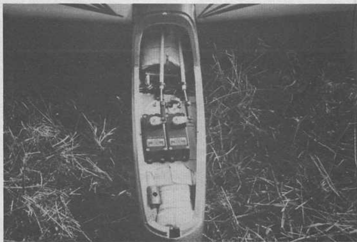
Vue de l'installation radio : 2 gros servos et un récepteur 8 voies rentrent aisément.
