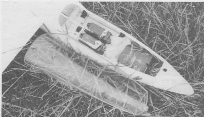
L'installation radio : les 2 servos de direction et profondeur, le récepteur et tout à l'avant la batterie.
