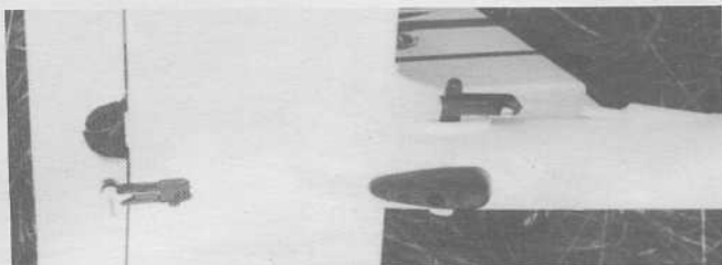
Les sorties des commandes. L'ouverture en demi cercle du volet du stab. permet le passage de l'élastique de fixation.
