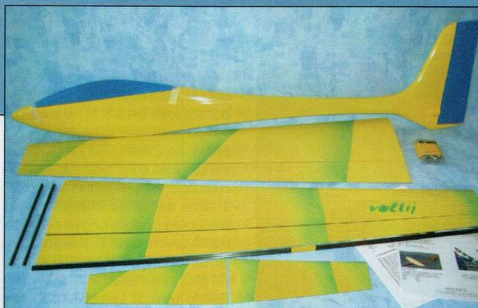
Le kit retenu pour cet essai est la version «Optimal», c'est-à-dire intégrant les options «carbone» : c'est donc à la fois léger et rigide.
