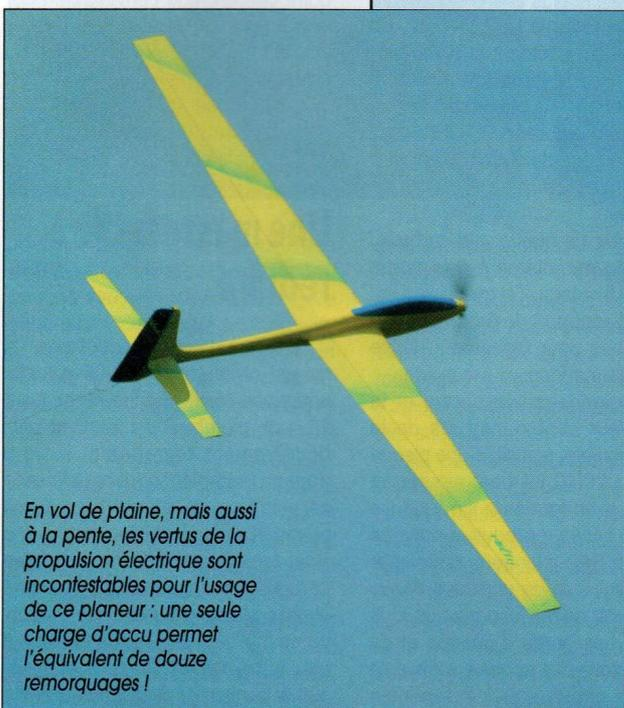
*En vol de plaine, mais aussi à la pente, les vertus de la propulsion électrique sont incontestables pour l'usage de ce planeur : une seule charge d'accu permet l'équivalent de douze remorquages !*
