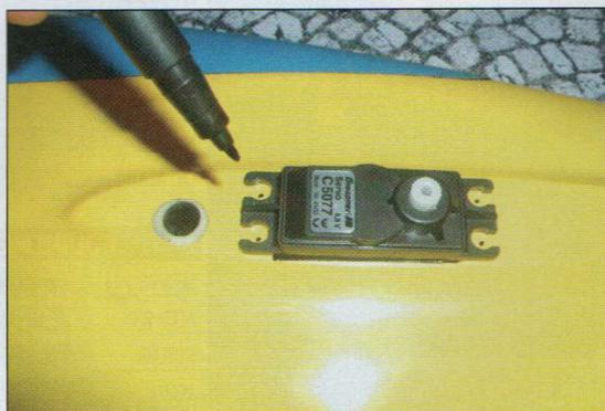
Les servos d'ailerons solidaires du fuselage attaquent leurs gouvernes via de courtes commandes à l'intrados.
