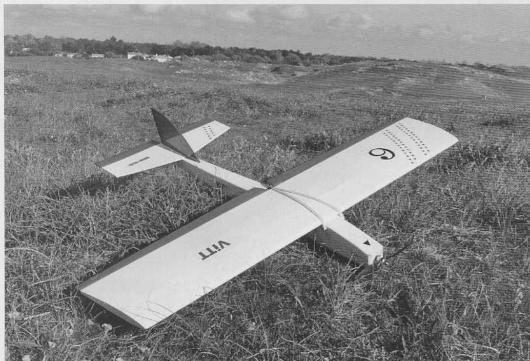
L'auteur a choisi un film thermorétractable Oracover pour entoiler son modèle mais on pourra utiliser du papier Kraft, une solution économique.
