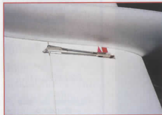
Une fois "emboîtée", l'aile ne laisse dépasser que le palonnier du servo qui attaque l'aileron à son emplanture, d'où la nécessité de rigidifier cette gouverne.
