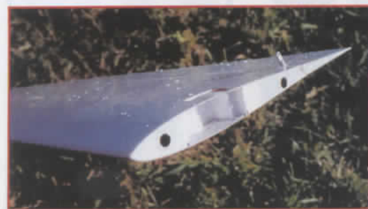
L'emplanture de chaque aile doit être creusée pour accueillir la tête du servo de son aileron.
