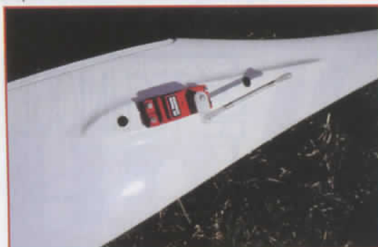
Les servos d'ailerons sont fixés directement sur les karmans du fuselage : un montage surprenant qui permet quelques simplifications très pragmatiques !
