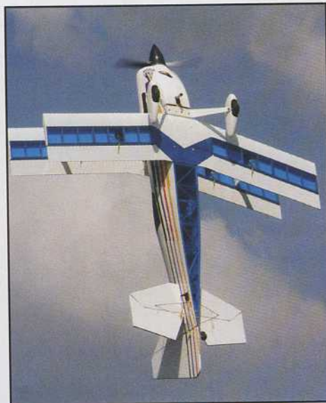
Idéal pour travailler le Torque Roll, l'Ultimate dispose d'une belle réserve de puissance : 50 cc pour 7,3 kg...
