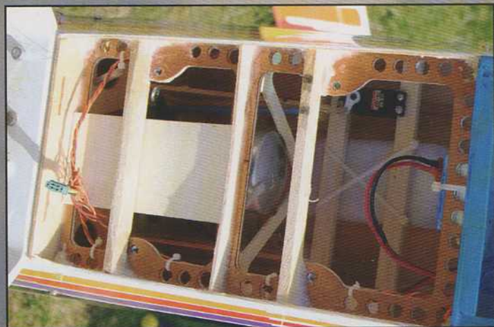
L'ouverture du fuselage, aile inférieure déposée, laisse voir la structure en ctp de bouleau qui confère tant de légèreté à cet avion imposant.
