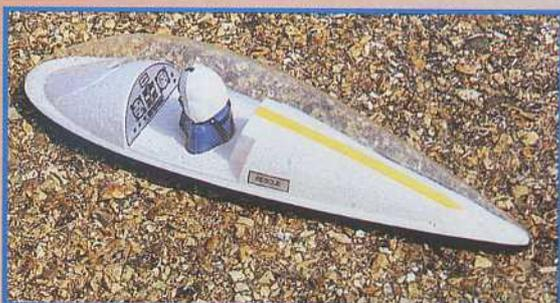
**Voici les points forts de ces ready to fly : en haut, il reste à fixer les servos, les commandes sont assemblées et mises en place d'origine. Au milieu, la dérive qui reste démontable, les fixations de train et le bâti moteur en place, commande de gaz déjà posée ! Enfin, à gauche, la verrière totalement assemblée d'origine et qu'il suffit de visser en place. Le Usky existe en plusieurs décors dont une jaune que l'on découvre ici.**
