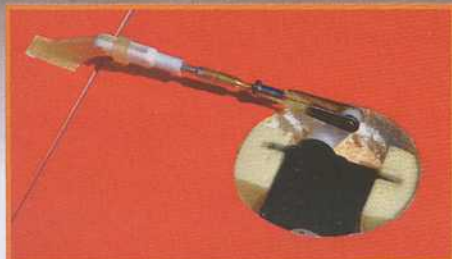
Notez le décalage du palonnier pour conserver du débattement en position aérofreins.
