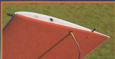
Sortie du cordon de servo d'aileron à l'intrados. La clé est de 6 mm de diamètre.
