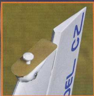
Sortie du cordon de servo d'aileron à l'intrados. La clé est de 6 mm de diamètre.
