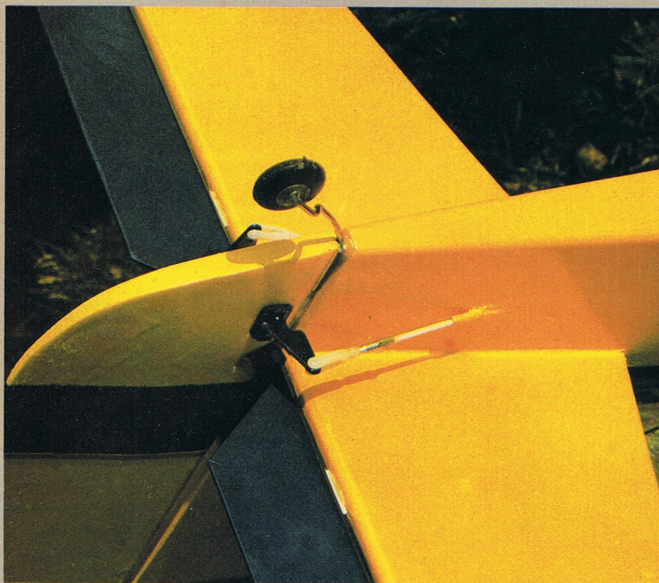
Gros plan sur la roulette de queue orientable et la sortie des commandes de direction et profondeur réalisées par gaines plastique. Très conventionnel et sans problème. Ci-dessous, vue de face : noter les évidements du capot moteur en ABS ainsi que la position légèrement inclinée du moteur (pour pouvoir installer le silencieux).
