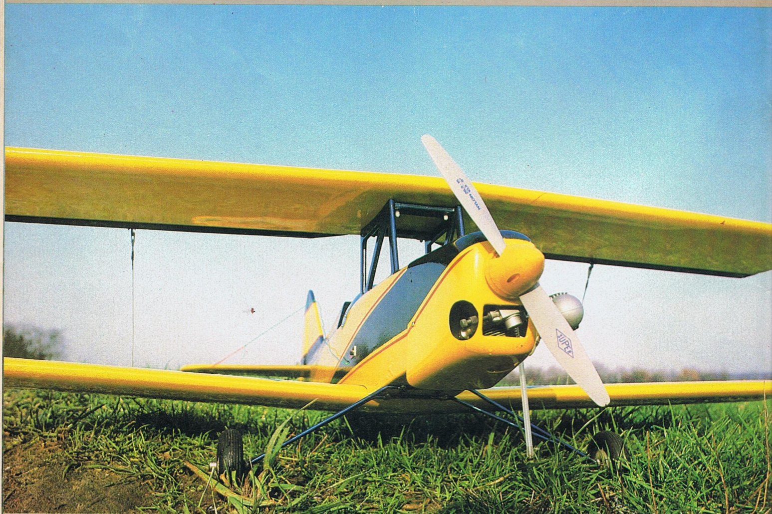
Gros plan sur la roulette de queue orientable et la sortie des commandes de direction et profondeur réalisées par gaines plastique. Très conventionnel et sans problème. Ci-dessous, vue de face : noter les évidements du capot moteur en ABS ainsi que la position légèrement inclinée du moteur (pour pouvoir installer le silencieux).
