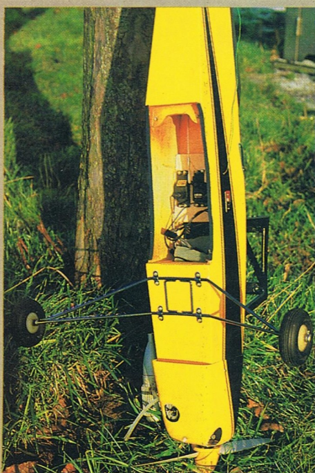
Esthétiquement, ce Tommy est plaisant, en particulier grâce à la géométrie et la disposition des ailes. Ci-dessus, noter l'important volume disponible dans le fuselage pour installer la radio. A remarquer également le fort joli train bicycle anodisé bleu.
