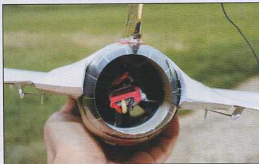
La sortie de tuyère n'a pas besoin d'être moulée : elle est simplement découpée dans une bouteille d'eau minérale.
