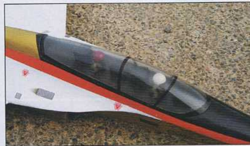
La verrière a été thermoformée sur une forme en plâtre. Elle a reçu par l'intérieur un voile de peinture «smoke» pour la teinter légèrement.
