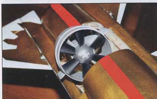
Mise en place de la turbine par l'ouverture ventrale. Le contrôleur loge juste derrière le moteur, à plat dans le conduit.
