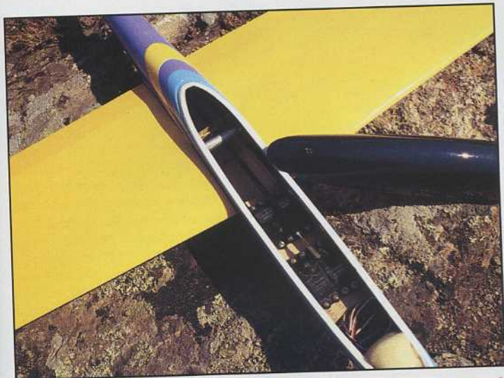
4 servos dans le fuselage, et la place ne manque pas !
