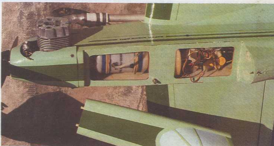
La partie supérieure de l'avant du fuselage est amovible, et donne accès à la radio et au réservoir.
