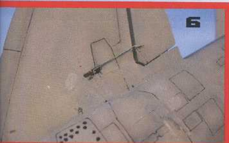
6) Chaque aileron est asservi par un servo.
