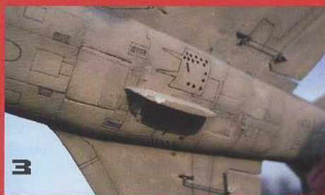
3) Pour optimiser la préhension du modèle lors du lancer, un pylône en Dépron® est ajouté sous le fuselage.
