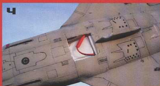
4 + 5) Deux trappes sont ménagées sous le fuselage. L'une favorise l'accès à la connexion de l'accu embarqué, l'autre au récepteur mini.
