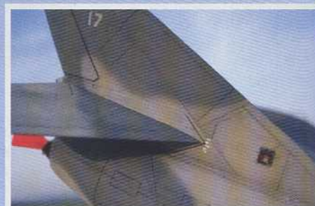
8) L'implantation des empennages avec la simulation des calages des deux plans de stabilisateur en degrés.
