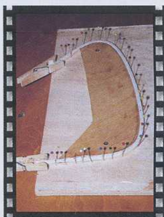
Fabrication de la dérive en lamellé collé
