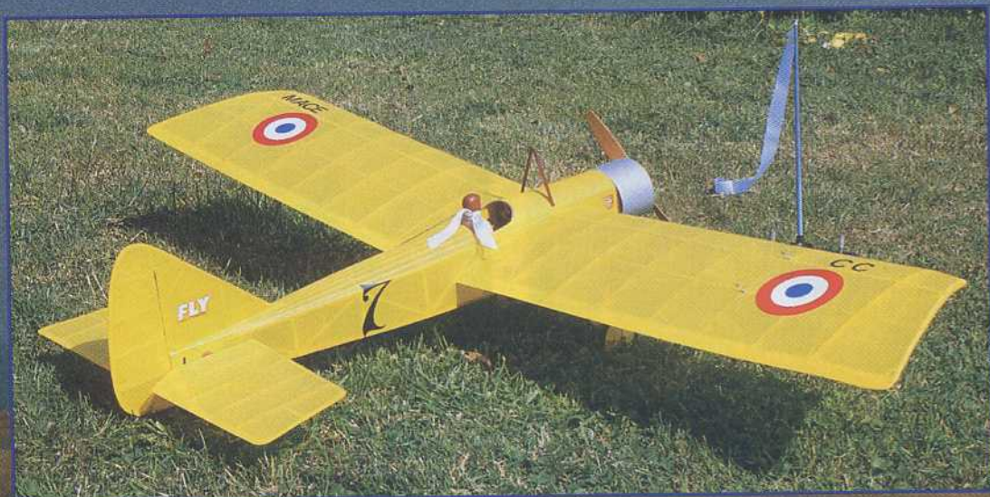
Les empennages s'écartent sérieusement de ceux du Baron d'origine, avec entre autre un stab pendulaire.
