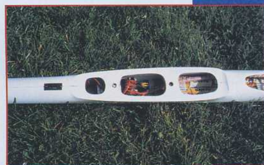
Pour la version électrique, l'ouverture découpée d'origine dans l'assise du fuselage (sur laquelle les ailes viennent se visser) permet de loger le récepteur.
