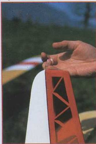
Pour faciliter le transport, le volet de dérive articulé avec les charnières fournies peut être démonté, ce qui réduit d'autant la longueur du fuselage.
