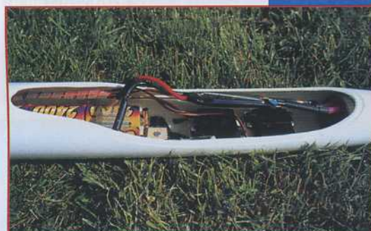
Le Sun électrique reçoit à l'avant du fuselage 2 mini-servos qui sont, au choix, vissés classiquement sur une platine (photo du haut), ou vissés à plat sur une platine collée plus bas dans le fuselage (photo ci-dessus).
