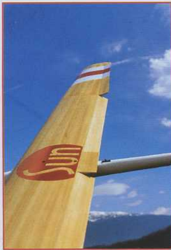
La notice manque un peu de précision quant aux réglages du planeur, mais cet article vous donne le détail des débattements retenus au terme des essais, notamment pour les ailerons et volets (articulés d'origine par un tissu placé lors du coffrage).
