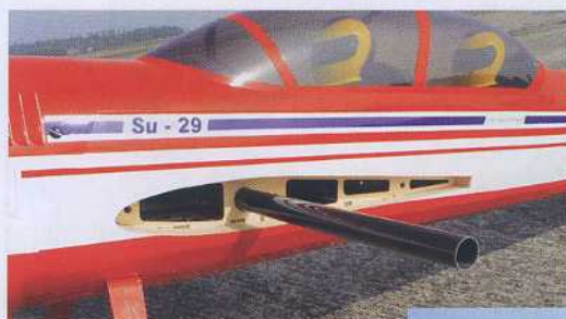
Les ailes s'encastrent dans le fuselage, le positionnement est donc assuré d'origine.
