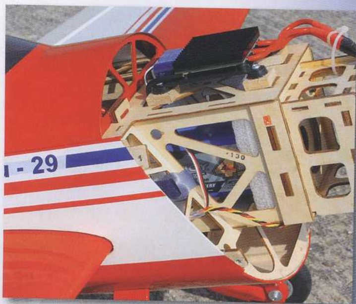
Capot déposé, on peut voir les cales en mousse qui positionnent les packs d'accus.
