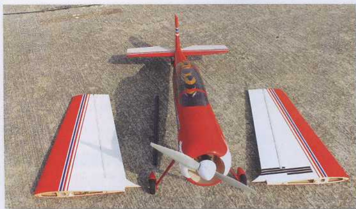
Les ailes en deux parties démontables, voilà qui facilite grandement le transport !
