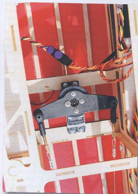
Le palonnier du servo de direction, à la géométrie étudiée pour des commandes restant parfaitement tendues.
