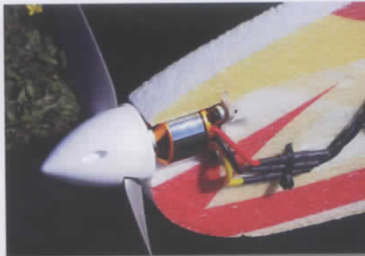
Le moteur est fixé sur un couple en contreplaqué.
