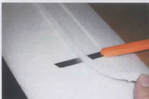
Découpe de la «fermeture» d'un fourreau à l'aintrados. Un cutter à lame neuve est indispensable.
