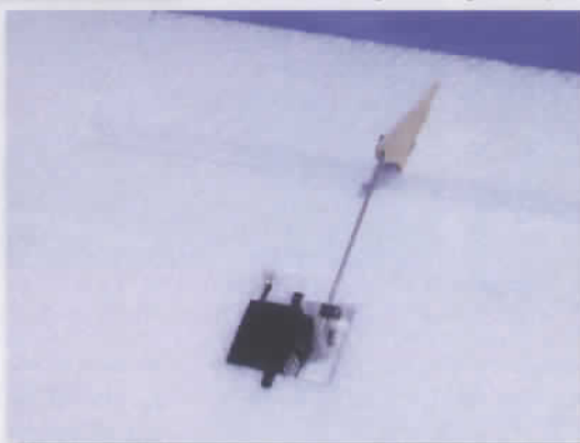
Installation d'un des servos d'ailerons.
