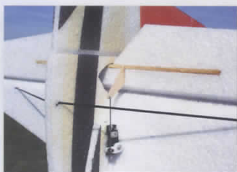
La commande de profondeur, avec le servo sous le stab.
