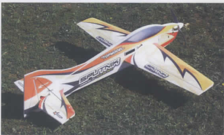
Plus long que son envergure, le Sputnik est dimensionné à la mode F3A et permet de travailler les programmes sur des terrains sommaires et à coût réduit.
