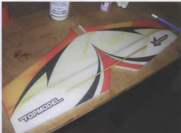
Préparation du stab : une latte de bois rigidifie la profondeur.
