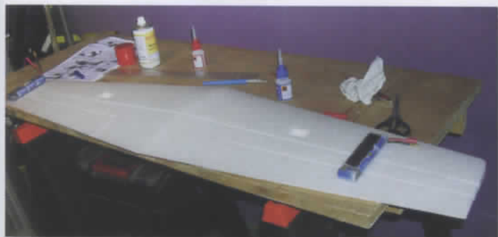
L'assemblage de l'aile à plat et à l'envers donne le dièdre léger qui «va bien».
