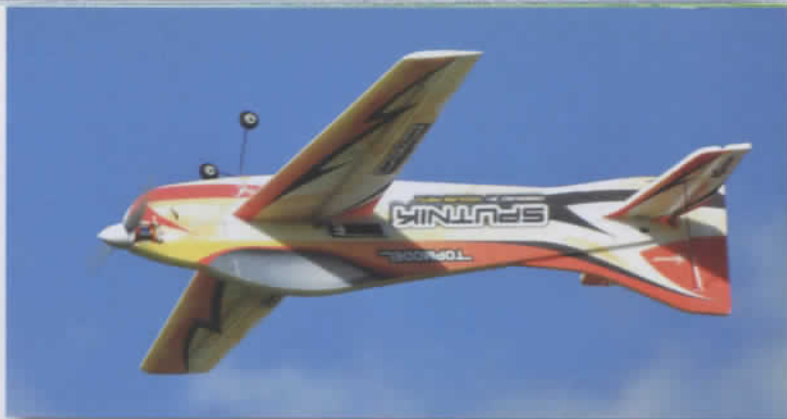
Grâce à son profil symétrique, le Sputnik vole aussi bien sur le dos qu'à l'endroit.
