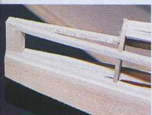
9) Collage d'une entretoise en balsa sous les deux lisses de fuselage (support futur du stabilisateur).
