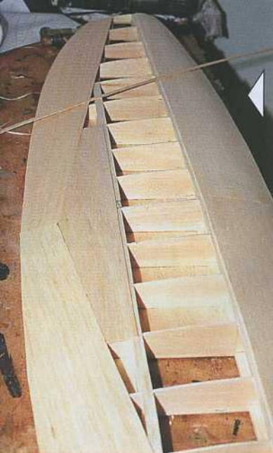
35) Après ponçage du coffrage pour affleurer le faux bord d'attaque, on peut coller la baguette de 50/10 qui sera poncée pour donner le vrai bord d'attaque de l'aile.
