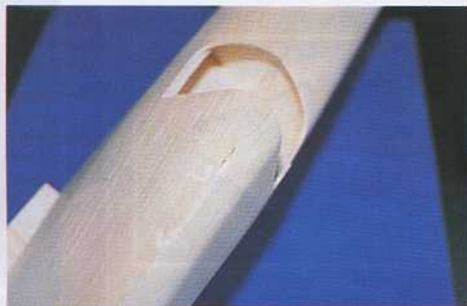
13) Découpe du coffrage au niveau du cockpit.
