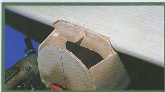
42) Perçage du logement du téton de fixation avec l'aile en place pour assurer un bon positionnement.
