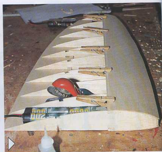
25) Coffrage de l'intrados de l'aile : partie avant et partie arrière.
