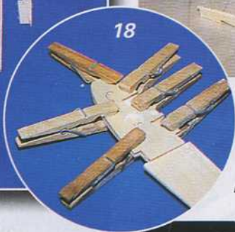
21) Collage des baguettes en bois dur supportant le mécanisme de train rentrant.
