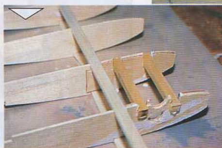
21) Collage des baguettes en bois dur supportant le mécanisme de train rentrant.
