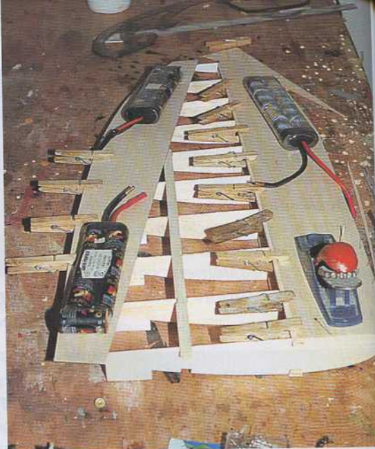
25) Coffrage de l'intrados de l'aile : partie avant et partie arrière.
