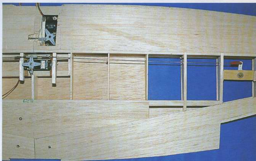
39) Installation du servo d'aileron et des commandes (corde à piano 15/10 + renvois d'angle).
