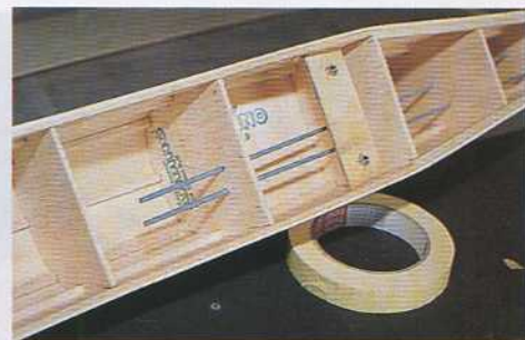
14) Pose des gaines de commande dans le fuselage.
