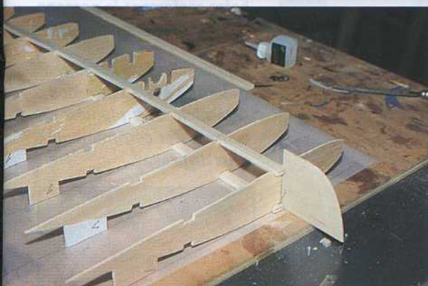
20) Pose du longeron d'intrados, la nervure 0 sera inclinée suivant le gabarit fourni sur le plan (réglage du dièdre pour l'assemblage des deux ailes).
