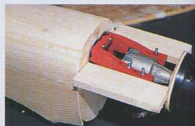
11) Mise en place provisoire du moteur pour réaliser la partie supérieure du capot : collage de deux morceaux de balsa de part et d'autre du bâti moteur.
