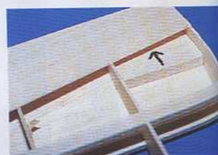
31) Collage des blocs de balsa renforçant le passage des vis de fixation de l'aile.
