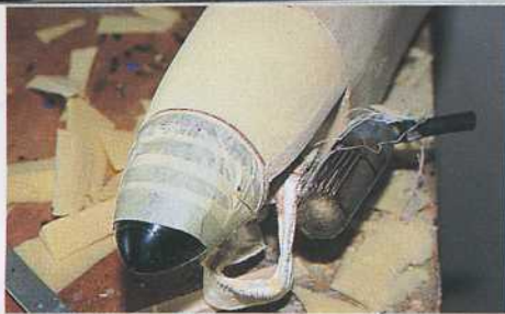
12) Réalisation du capot supérieur à l'aide d'un bloc de mousse de polyuréthane mis en forme (le balsa pourra également convenir). Le cône est protégé pour ne pas être griffé.
