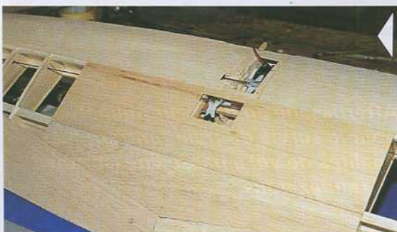
39) Installation du servo d'aileron et des commandes (corde à piano 15/10 + renvois d'angle).
