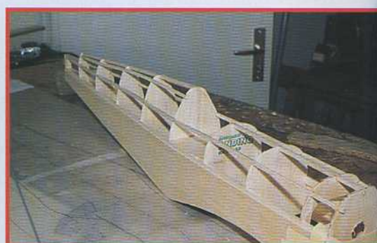
8) Collage du couple moteur sur les flancs et mise en place des lisses supérieures.
