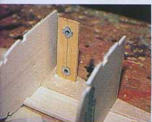
6) Préparation de la pièce 6 avec ses deux écrous à griffes et collage de cette pièce sur le flanc.
