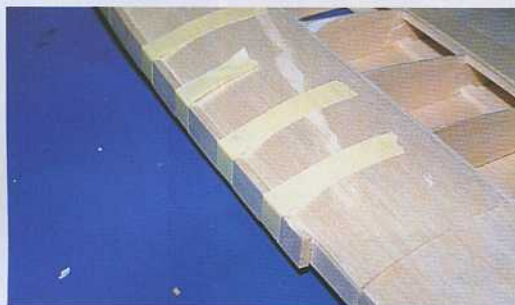
35) Après ponçage du coffrage pour affleurer le faux bord d'attaque, on peut coller la baguette de 50/10 qui sera poncée pour donner le vrai bord d'attaque de l'aile.
