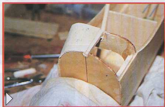
14) Pose des gaines de commande dans le fuselage.
