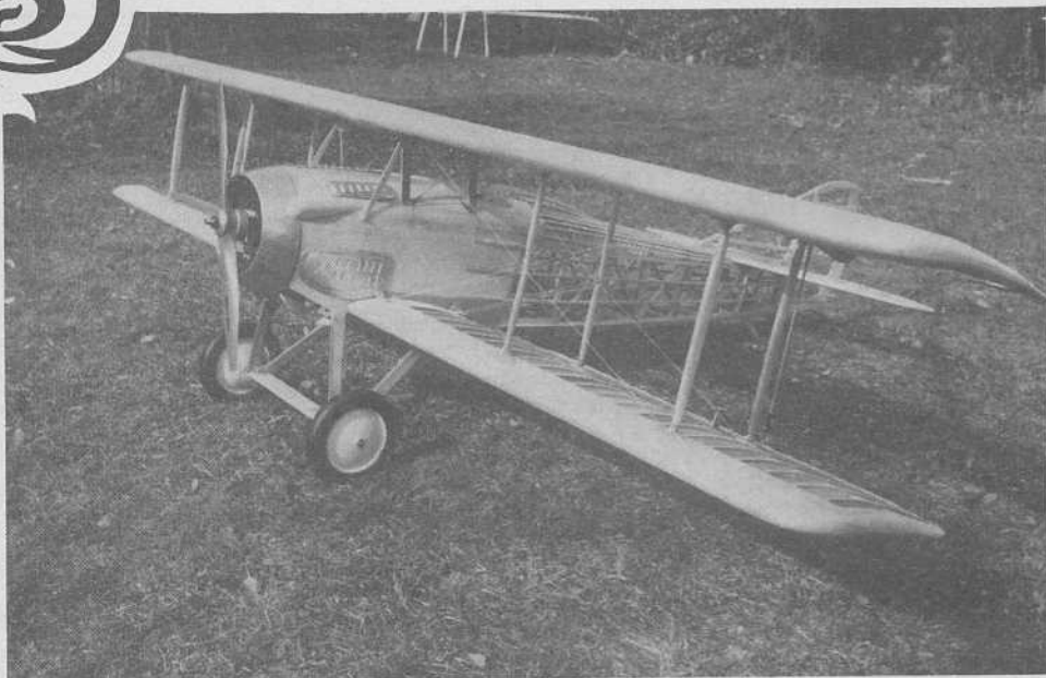
2 vues du Spad assemblé, avant entollage. Vous noterez le capot en bois non encore recouvert d'alu, les lisses permettant de donner le relief sous l'entollage du fuselage et le coffrage des ailes.
