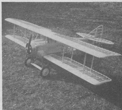
2 vues du Spad assemblé, avant entollage. Vous noterez le capot en bois non encore recouvert d'alu, les lisses permettant de donner le relief sous l'entollage du fuselage et le coffrage des ailes.
